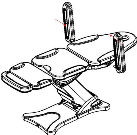
2. Manuelle Steuerungsfunktion (Hubhöhe: das Bett ist 58 ~ 82 cm vom Boden entfernt)
