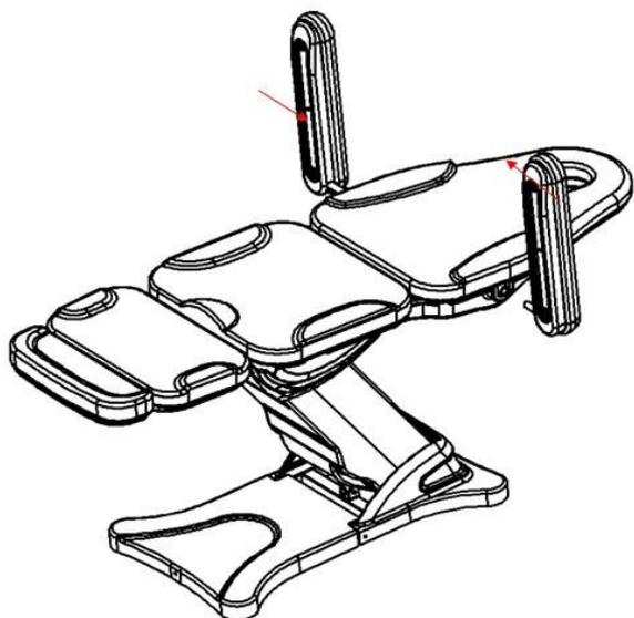
2. Fonction de commande manuelle (hauteur de levage : le lit est à 58 ~ 82 cm du sol)
